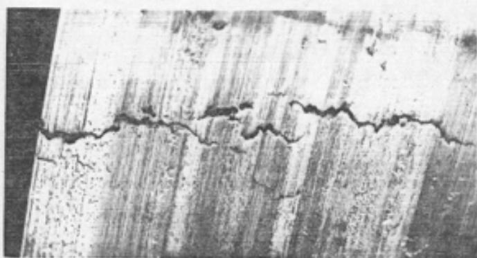
照片23. 铸钢40Cr中的热裂纹(磁探)
